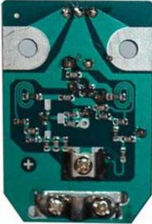
В районах с недостаточным уровнем принимаемого сигнала используют двухкаскадные (двухступенчатые) усилители РАЕ-65. Подача напряжения к пластинчатым усилителям осуществляется адаптерами, различающимися лишь исполнением корпуса, напряжением на выходе 12В.
