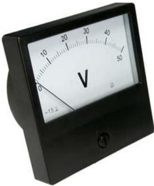
Вольтметр М42300 предназначен для измерений напряжения в электрических цепях постоянного тока. Приборы представляют собой щитовые приборы магнитоэлектрической системы с внутрирамочным магнитом; Измерительный механизм прибора состоит из магнитной системы (обойма, магнитопровод), отсчетного устройства (шкала, указатель) и подвижной части на кернах;
