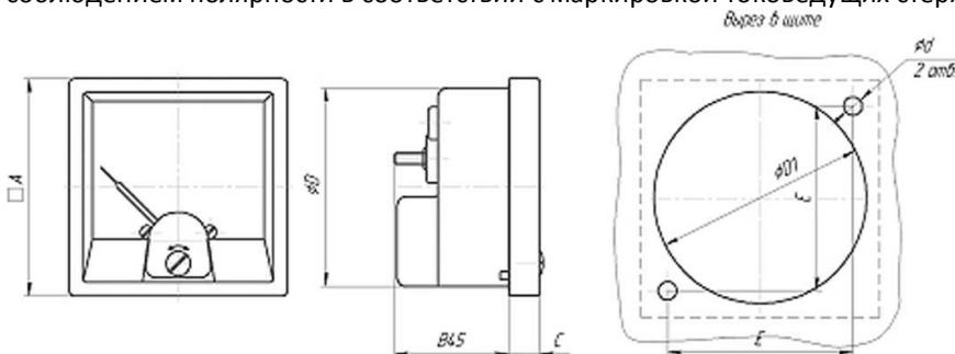
где А - 60мм, В - 35мм, С - 11мм, D - 54,6мм, D1 - 57,5мм, d - 3,4мм, Е - 50мм;
