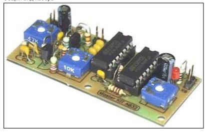
"Оживить" любимых героев мультипликационных фильмов Вам поможет схема, преобразующая голос человека в голос робота, придав ему характерные металлические интонации. Устройство включается между микрофоном или магнитофоном и усилителем мощности.
