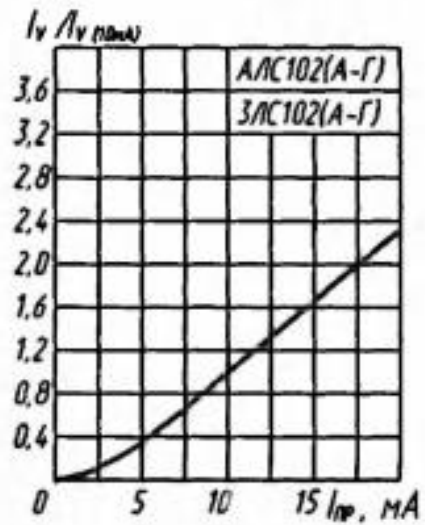
Зависимость силы света от тока
