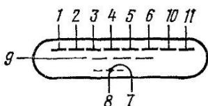
Выводы электродов: 1—6, 10, 11 — аноды-сегменты; 7 — катод; 8 — катод, проводящий слой на внутренней поверхности баллона; 9 — сетка (маска).
