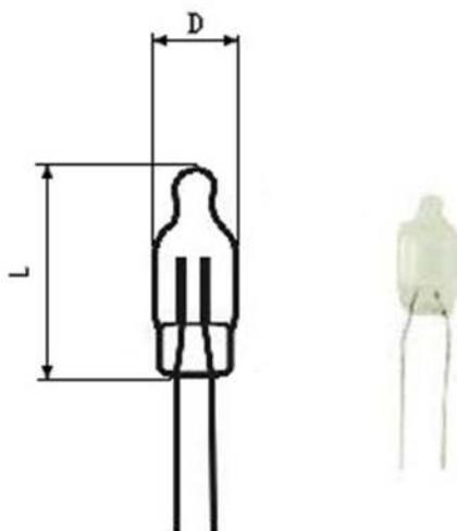
Рабочее напряжение 100 в,  $D = 6$  мм,  $L = 15$  мм. Цвет свечения зелёный. Длинные гибкие выводы.
