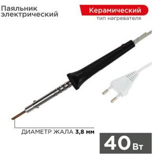
Паяльник с керамическим нагревателем серии ЭПСН мощностью 40Вт предназначен для ручного монтажа/демонтажа электронных компонентов и других мелких и средних деталей. Подходит как для любительского, так и для профессионального использования. Медное жало выполнено в скошенной форме (45), в случае необходимости его можно легко и быстро заменить (сменное жало в комплект не входит).
