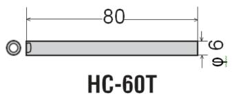
НС-60Т легко оплавляет заклепки до 6 мм в диаметре. Толстое хромовое покрытие жала предотвращает прилипание рабочих отходов.
