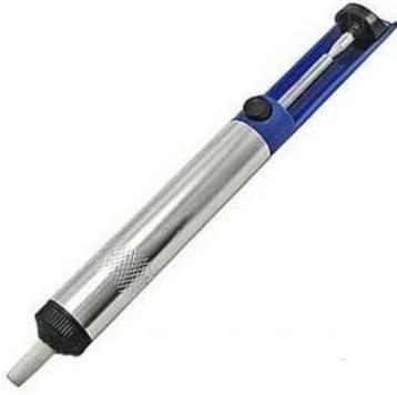
Очень удобен в использовании благодаря автоматическому срабатыванию штока с поршнем при нажатии на кнопку фиксатора. Застывший припой затем удаляется штоком из сопла шприца повторным нажатием на колпак. Корпус шприца металлический. Шприц применяется совместно с электропаяльником для удаления оловянно-свинцового припоя с печатных плат и других мест пайки. Пригоден как при выпаивании электронных элементов и проводников, так и при последующей зачистке платы.
