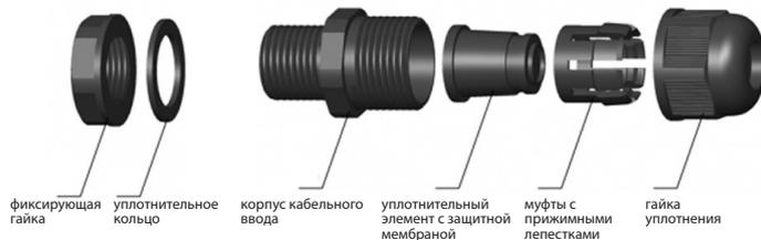
Рис.4. Конструктивные элементы сальника (кабельного ввода) MG
