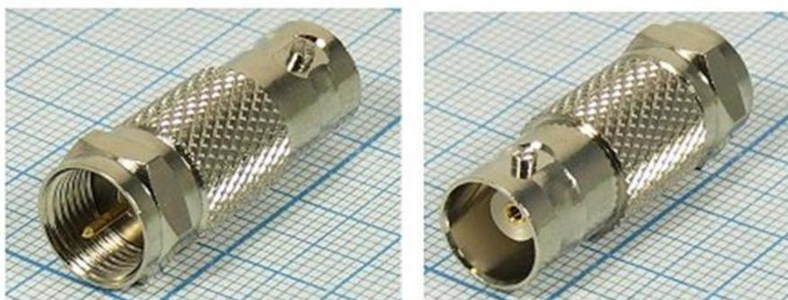
Переходник предназначен для стыковки кабелей и приборов, имеющих соответствующие ответные части ВЧ разъемов стандарта BNC и F-типа. Переходник имеет позолоченный центральный проводник и никелированный (хромированный) корпус. Изолятор, как правило, изготовлен из фторопласта.
