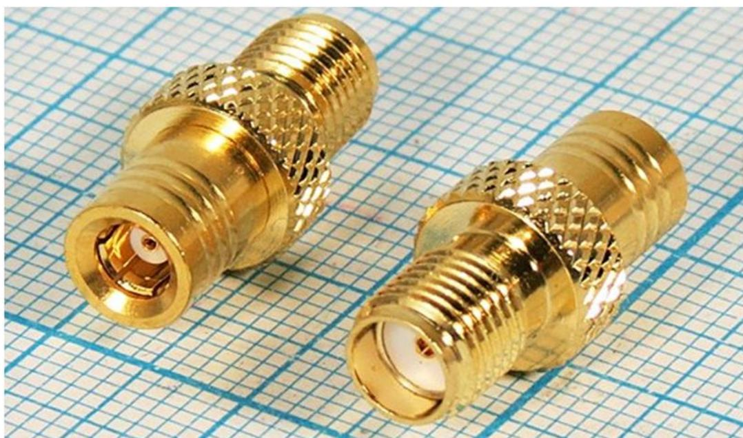
Переходник предназначен для стыковки кабелей и приборов, имеющих соответствующие ответные части разъемов стандарта SMB и SMA. Переходник имеет позолоченный центральный проводник и позолоченный корпус. Изолятор, как правило, изготовлен из фторопласта.
