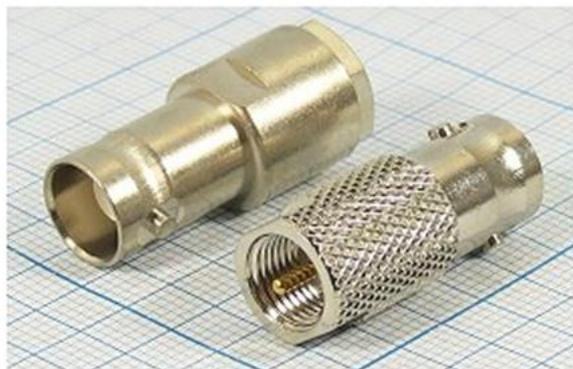
Переходник предназначен для стыковки кабелей и приборов, имеющих соответствующие ответные части разъемов FME и BNC. Переходник имеет позолоченный центральный проводник и хромированный корпус. Изолятор, как правило, изготовлен из фторопласта.
