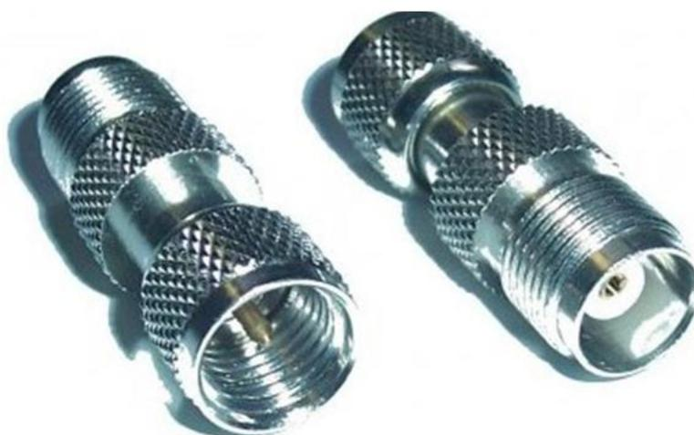
Переходник предназначен для стыковки кабелей и приборов, имеющих соответствующие ответные части ВЧ разъемов стандарта mini-UHF и TNC. Переходник имеет позолоченный центральный проводник и хромированный корпус. Изолятор, как правило, изготовлен из фторопласта.
