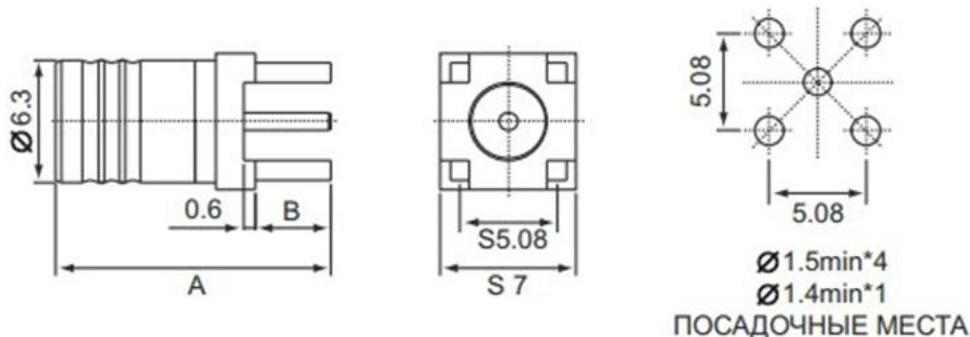
Разъем имеет позолоченный центральный проводник и позолоченный корпус. Изолятор, как правило, изготовлен из фторопласта.
