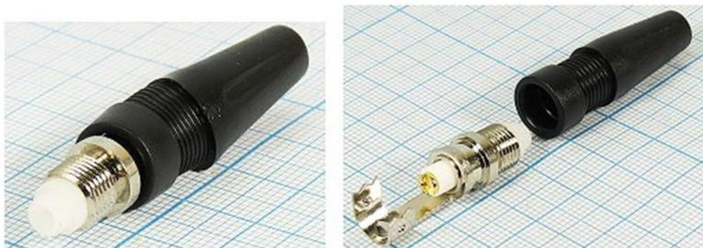
Разъемы предназначены для быстрого монтажа без применения пайки. Крепление центрального проводника производится винтом, оплетка кабеля обжимается. Возможно применение различных коаксиальных кабелей с внешним диаметром оболочки 6 мм. Разъем имеет никелированный центральный проводник и хромированный корпус. Изолятор, как правило, изготовлен из фторопласта.
