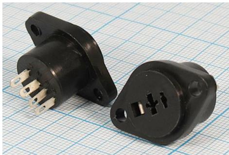
DIN-разъём для акустических систем, называемый также «точка-тире». Поляризованный двухконтактный неэкранированный разъём, разработанный для подключения громкоговорителя к усилителю мощности звуковой частоты или другому устройству. Он существует в виде гнезда для монтажа на панель. Гнезда или штекера на кабель. Круглый контакт подключается к положительному полюсу (красный), а плоский — к отрицательному (чёрный).
