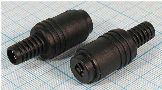
DIN-разъём для акустических систем, называемый также «точка-тире». Поляризованный двухконтактный неэкранированный разъём, разработанный для подключения громкоговорителя к усилителю мощности звуковой частоты или другому устройству. Он существует в виде гнезда для монтажа на панель. Гнезда или штекера на кабель. Круглый контакт подключается к положительному полюсу (красный), а плоский — к отрицательному (чёрный).
